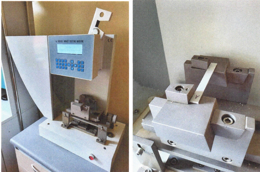
Rys. 6. Młot udarowościowy XJ 5Z (Liangong, Chiny) oraz usytuowanie w nim próbki (po prawej)
