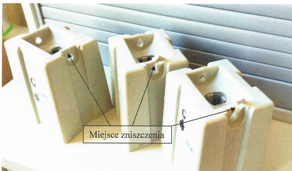
Rys. 27. Próba C po starzeniu, próbki po zniszczeniu
