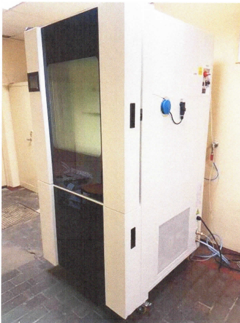
Rys. 8. Komora klimatyczna CCK 40/300NG (Dycometal, Hiszpania)
